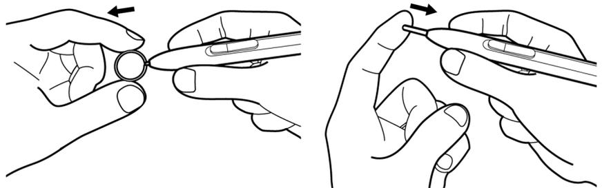
2. Introduisez l'extrémité de la nouvelle pointe dans le fourreau du stylet. Poussez fermement la pointe jusqu'à ce qu'elle se bloque.
