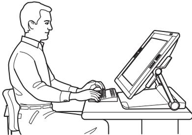
キーボードでたくさんの文字を入力する場合は、液晶ペンタブレット本体を斜めに調節します。作業内容を他の人に見せる際にもこの角度が便利です。支持脚を引き出して、キーボードを液晶ペンタブレット本体の下に置くこともできます。
