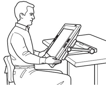
低い位置で作業をするには、液晶ペンタブレット本体を机上から張り出す位置に調節します。
