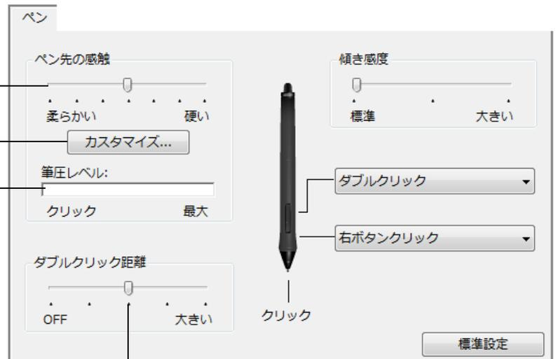
ダブルクリックする領域の大きさを調整します。
