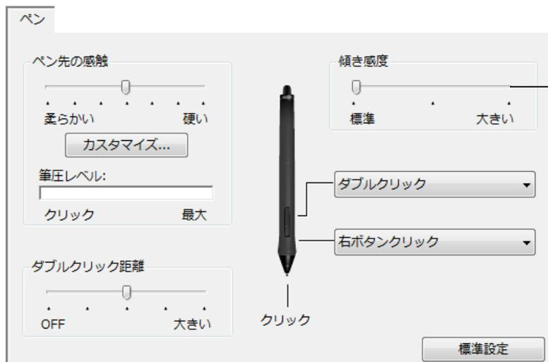
スライダをドラッグして、「傾き感度」の高低を調整してください。次に、傾きをサポートするソフトウェアで新しい設定をテストします。
