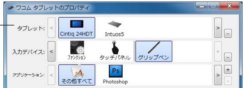
新しいペンタブレットを追加する場合は、ペンタブレットをコンピュータに接続します。システムは自動的に新しいペンタブレットを検出して初期化し、コントロールパネルにそのペンタブレットのアイコンを表示します。
