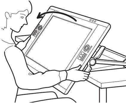
4. 作業が終わったら、角度調整レバーで画面を立て、液晶ペンタブレット本体を完全に作業台の上に戻します。本機を使用していないときは、完全に作業台の上に載っていることを確認してください。
